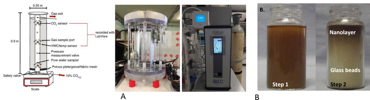
Figure 1. A : colonne décimétrique pour les essais sable/brucite, avec au centre, la colonne avant montage et le générateur/mélangeur de gaz CEMLab (plateforme MIMAROC) ; et B : milieu poreux à distribution contrôlée
